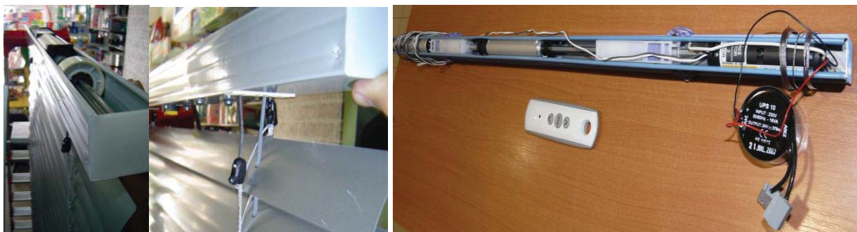
Fig. 1. Sistem de strângere si desfacere a jaluzelei cu mecanism tip scripete cu fir [1]
