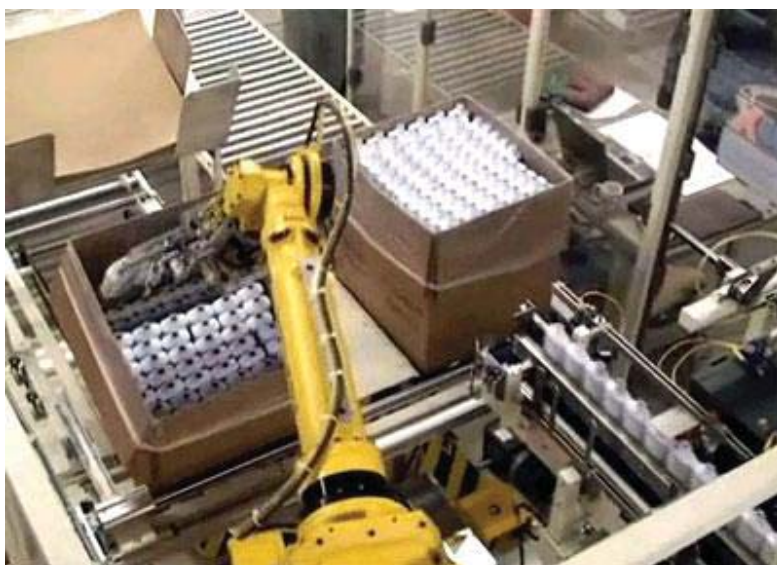
Fig. 2 Aplicație pentru împachetarea recipientelor din plastic [2]
