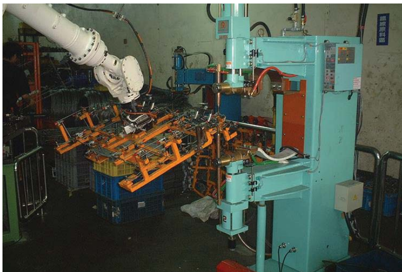
Fig. 3. Aplicație de aservire pentru sudarea în puncte a unor piese [3]
