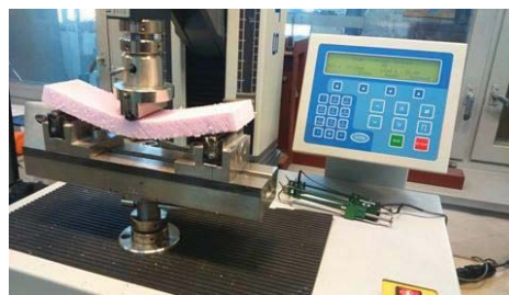
Fig. 2. Testarea la încovoiere a polistirenului extrudat
